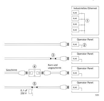
In einigen industriellen Ethernet-Einheiten ist die Abschirmung des RJ45-Anschlusses über einen Kondensator mit dem Gehäuse verbunden, siehe 1 in der Zeichnung oben.
