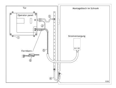
Die Befestigungsschellen des Operator Panelsstellen keine sichere Erdungsverbindung zwischen Panel und Geräteschrank dar, siehe 1 in der Zeichnung oben.
