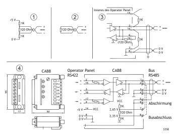
Einige (ältere) Operator Panels besaßen Pullup- und Pulldown-Widerstände, mit Ausnahme des eigentlichen Busabschlusses mit  $120\,\Omega$ , vergleichbar mit Westermo und Profibus. Siehe 1 in der Zeichnung oben.
