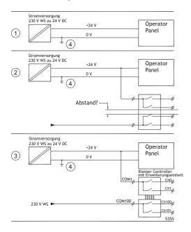
Wenn Sie eine Stromversorgung einsetzen, die den Sicherheitsstandards entspricht und ausschließlich das Operator Panel speist, besteht kein Problem. Siehe 1 in der Zeichnung oben.
